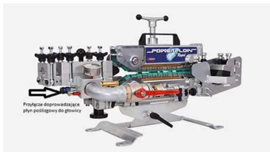
Maszyna Fremco ze zintegrowaną z głowicą smarownicą kabla.
