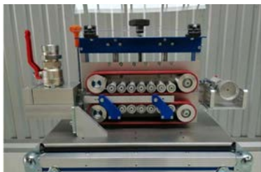
Fot. 8. Maszyna do wdmuchiwania pakietów mikrorurek z podajnikiem paskowym (Gamm-Bud)
