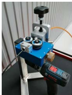
Fot. 9. Wdmuchiarka do mikrokabli napędzana wkrętarką (Gamm-Bud)
